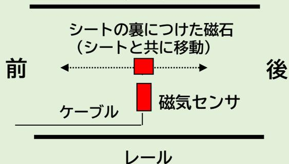
1回のストロークの間に、磁気センサの上を磁石は2回通過します。
