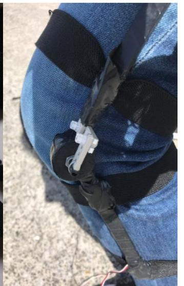
整調のシートの裏面に磁石を貼り付け、その下の艇側に磁気スイッチを設置。通過する磁石を検知し、経過時間からレートを計算する。整調が漕がないとレートが分からない。装着時間がかかるので、その後、加速度センサでレート判定する方式にCKGの改良を図る。昔のNK製品も上記のような磁気スイッチでレートを計測していたが、今はNKの製品は加速度センサでSurge（前後加速度を算出）を計測し判定している（内部ロジックは不明）。
